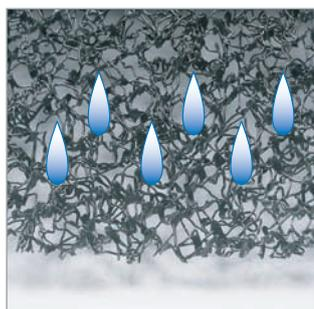
Grid sec 350 è un tessuto monofilamentoso composto da materiale plastico con uno spessore di 8mm, senza membrana di tenuta Permo® (impermealizzante). Viene applicato sulle coperture sopra le membrane traspiranti per realizzare la microventilazione delle coperture metalliche.
